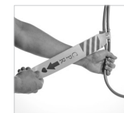
HLR-tömningsventilen är öppen.
