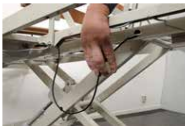
Steg 4: Dra (häng upp) givarens kabel parallellt med fotmotorns kabel i den långsgående balken
