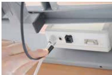
Steg 6: Anslut kabel till larmbox
