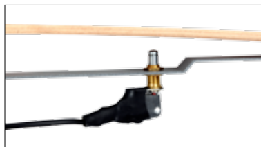
Flytta ner brytaren och lås fast låsringarna
