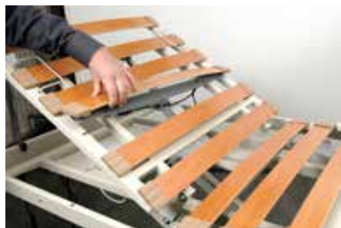
Steg 1: Demontera ryggdelens trälatta
