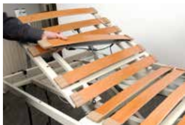
Steg 3: Montera sammansatt trälatta och givare i sängens ryggstöd. OBS! För att få rätt kabellängd – kör upp ryggstödet i högsta läget
