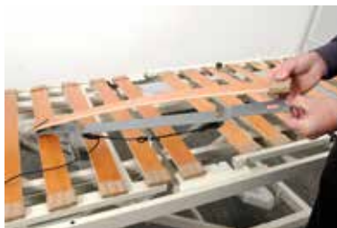
Steg 2: Montera trälattan på givaren (plåt med brytare)
