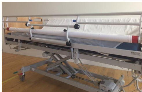
Bild 5.1 – Sänggrindsposition (under vändning) Den ena sidan har rullen längst upp och den andra sidan fungerar som sänggrind
